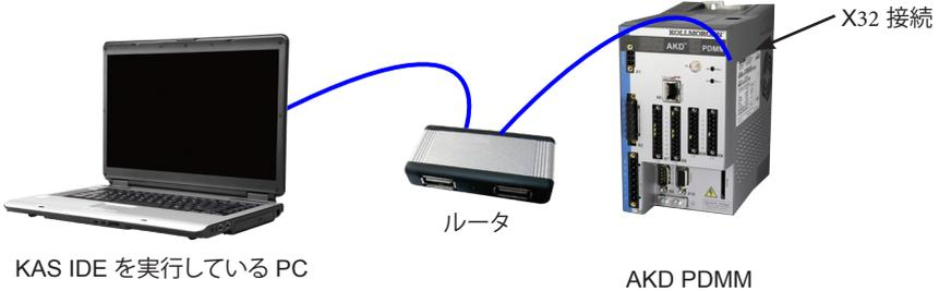
図 16. 接続方法 B:ルータへの接続
