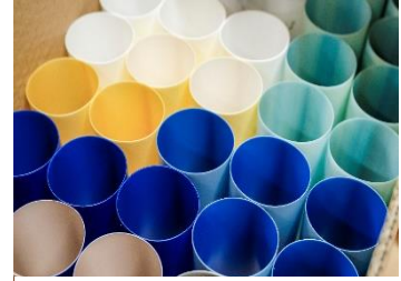
Kesimi tamamlanan borucuklar kusursuz olarak kesilmiş olmalıdır, böylece daha sonra baskıları ve diğer işlemler kusursuz olarak yapılabilir.
