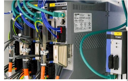
Hareket kumandası PCMM ve servo güçlendirici AKD’nin kombinasyonu Breyer’de kompakt ve yüksek performanslı bir hareket kontrol bileşeni oluşturuyor.
