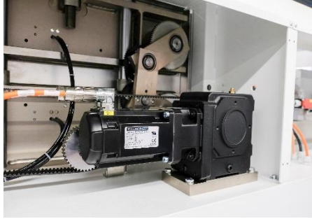
Çektirme beslemesi ve bıçak tahriki için iki AKM servo motoru kullanılıyor.
