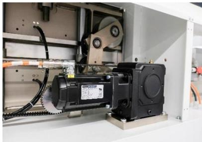
Per lo spostamento del caterpillar e per l'azionamento dei coltelli si utilizzano due motori AKM
