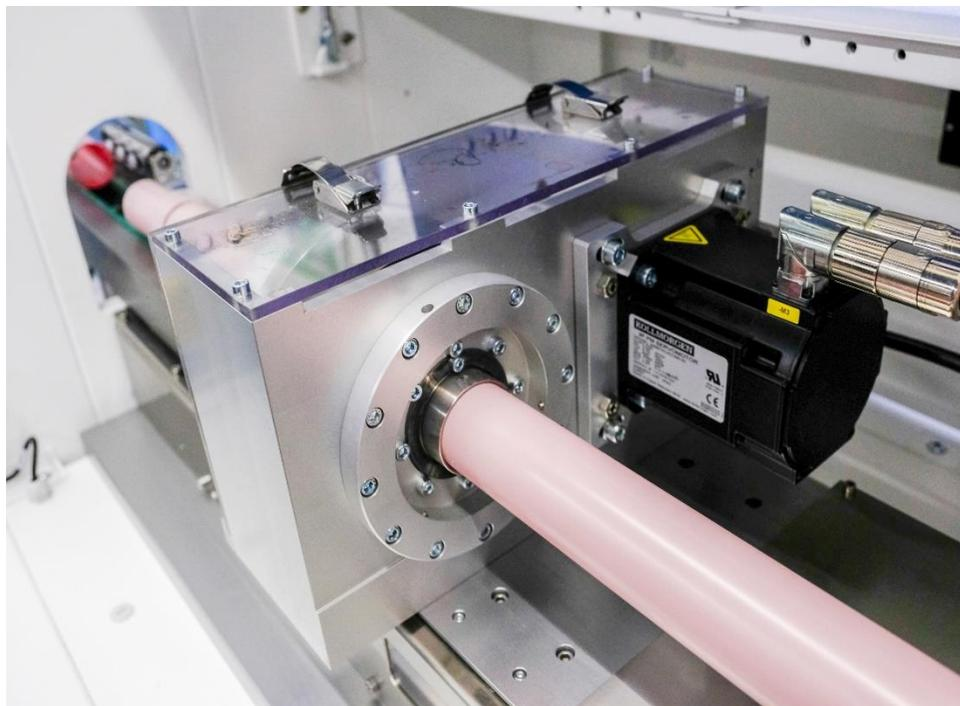
*L'unità di taglio con un servomotore AKM come azionamento viene posizionata da un motore lineare ICH in modo sincronizzato rispetto alla velocità di produzione.*
