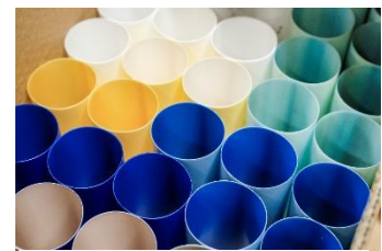
Die fertig geschnittenen Rohlinge müssen exakt geschnitten sein, damit sie sich später präzise bedrucken und weiterverarbeiten lassen.
