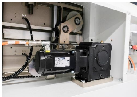
Für den Raupenvorschub und den Messerantrieb kommen zwei AKM-Servomotoren zum Einsatz.
