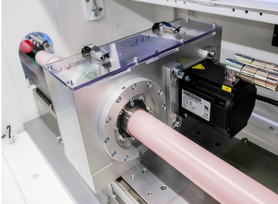
Die Schneideinheit mit einem AKM-Motor als Antrieb wird von einem ICH-Linearmotor synchron zur Produktionsgeschwindigkeit positioniert.
