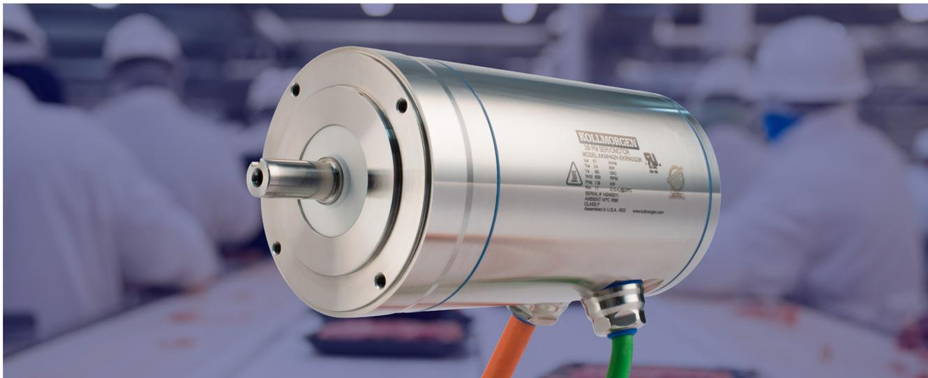
"A parte externa do AKMH é toda de aço inoxidável 316. Além disso, é completamente polida e apresenta uma rugosidade superficial melhor que 0,8 µm. Todas as vedações e o-rings também cumprem os mais estritos requisitos sanitários. Até a placa de identificação do motor é gravada a laser na carcaça. Os motores da Kollmorgen em aço inoxidável são o que há de melhor em produção de embalagens de alimentos."
