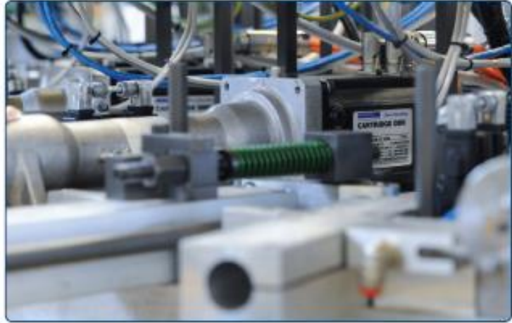
Torquemotoren der Reihe Cartridge DDR sind direkt mit der Achse für die Gläserpositionierung verbunden. Die Vorteile: Kein Getriebe, weniger Spiel, mehr Platz.
