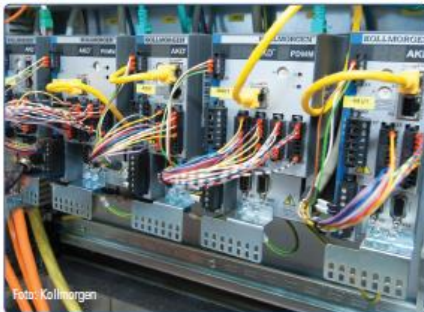
Die intelligenten Servoumrichter der Reihe AKD PDMM bieten die Rechenleistung eines „IPC inside“. Kommuniziert wird bei Schleuter per EtherCAT.
