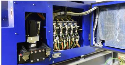
Risulta quindi evidente perché, al di là di fattori apparentemente secondari come la collaborazione in fase di progettazione o la pronta assistenza, è importante che la tecnologia di servoazionamento possa essere integrata con il minor ingombro possibile. "La scarsa profondità dell'armadio elettrico è uno dei motivi per cui i nostri tecnici hanno scelto i servoazionamenti AKD", rivela il manager.
