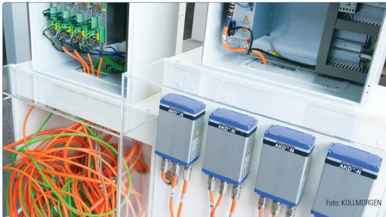
*Più ordine nella massa di cavi: se si utilizzano servozionamenti accanto ai motori, si può fare a meno dell'elaborato cablaggio di potenza da un armadio di controllo centrale. L'installazione diventa più chiara.*
