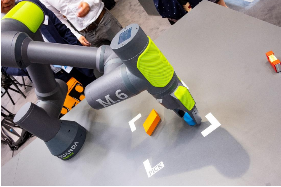
M.6'nın ortalama taşıma kapasitesi 6 ila 8 kg (M) ve altı tahrik biriminden oluşuyor (6)
