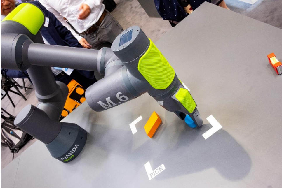
Il modello M.6 ha una capacità media di carico compresa tra 6 e 8 kg (M) ed è costituito da sei unità di azionamento (6).
