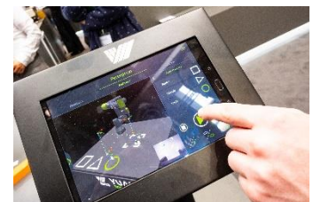
Non occorrono più conoscenze specifiche per programmare un robot: la visualizzazione 3D con le possibilità offerte dalla “augmented reality” rivoluziona la fase di messa in funzione.
