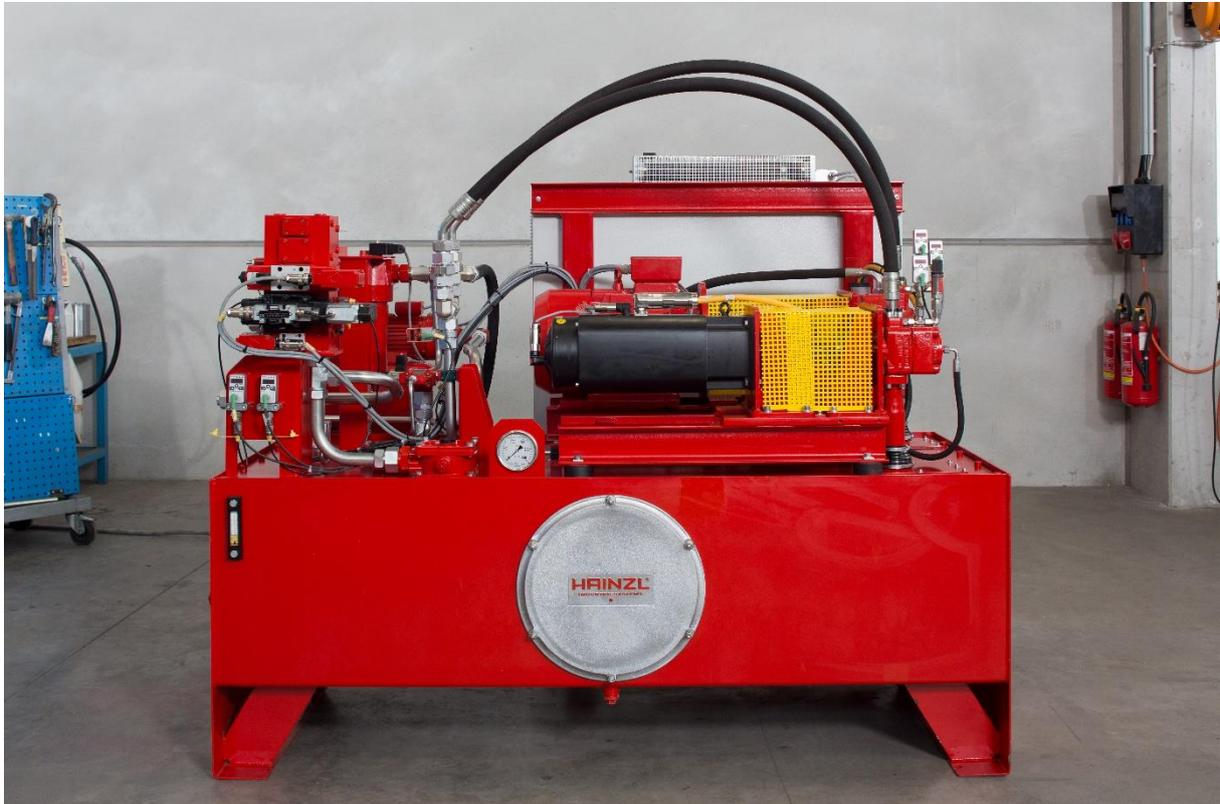
*Der Hauptvorteil der Servoumrichter gesteuerte Hydraulik von Hainzl liegt in ihrer Einsatzmöglichkeit – unabhängig von einer zentralen Hydraulikversorgung.*
