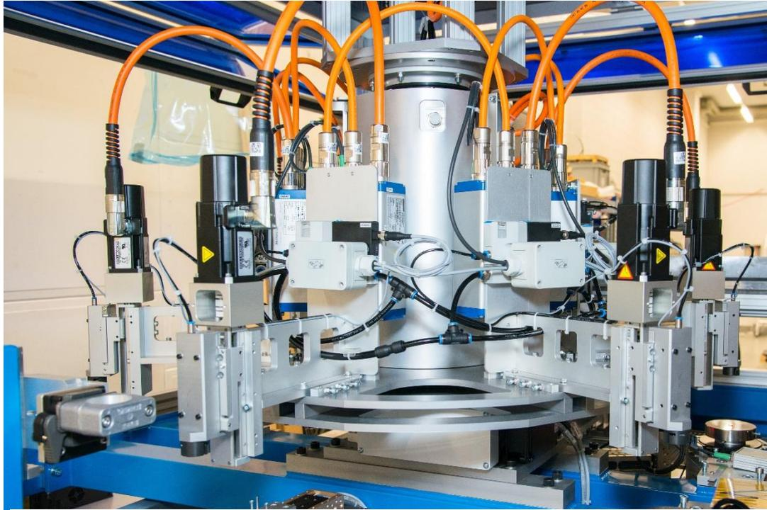
*Safe Torque Off (STO) in der Praxis: Ein Hersteller von Prüfanlagen aus der Schweiz nutzt bereits die TÜV-zertifizierte Sicherheitstechnik mit Schleifring und dezentralen KOLLMORGEN-Servoreglern AKD-N.*
