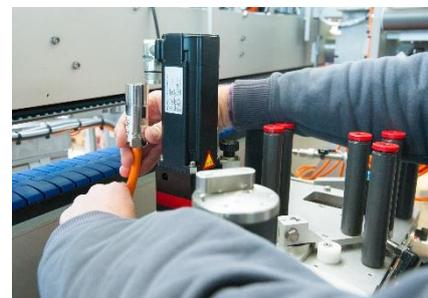
*Die AKM-Servomotoren lassen sich platzsparend und schnell montieren – auch dank der Einkabelanschlusstechnik*
