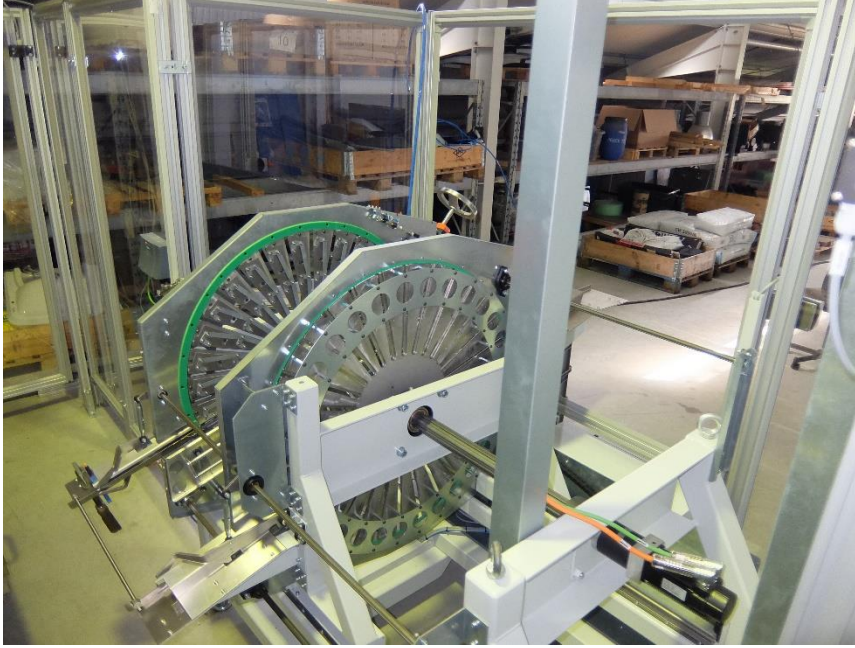
Borucuklara tamponlama uygulamak için tambur şarjörleri, Kollmorgen AKM servo motor tarafından tahrik ediliyor
