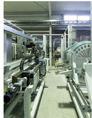
Vista dell'impianto, magazzino a tamburo, asse orientabile e testa di taglio
