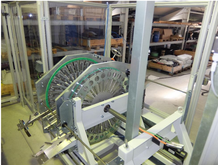
Magazzino a tamburo per l'accumulo dei pezzi grezzi, azionato da un Kollmorgen servomotore AKM
