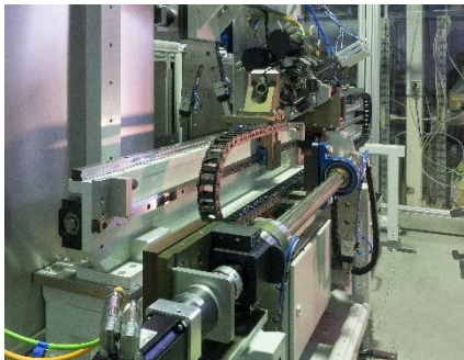
Schwenkachse zum Abholen der Rohlinge vom Trommelmagazin, angetrieben vom Kollmorgen AKM Servomotor.
