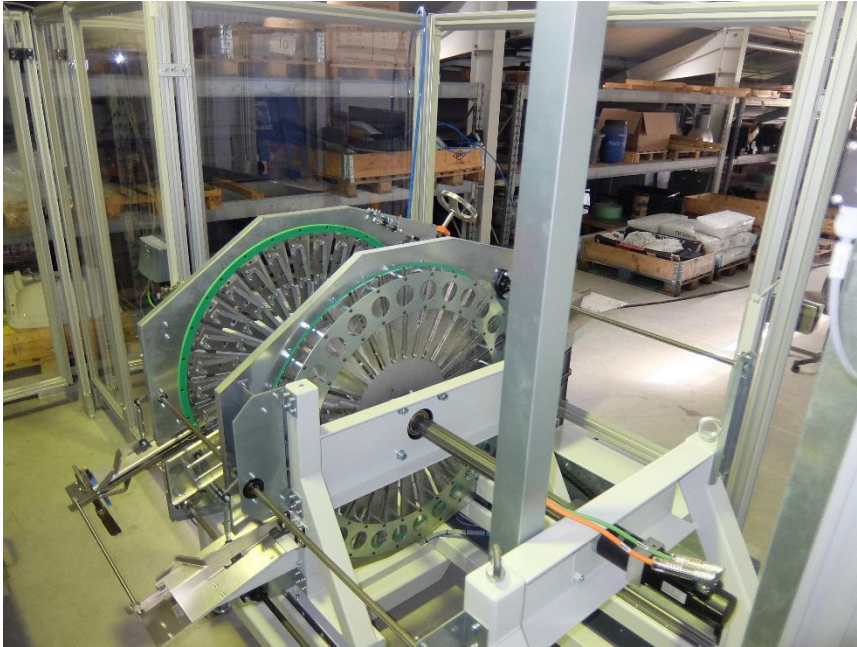
Trommelmagazin zum Puffern der Rohlinge, angetrieben vom Kollmorgen AKM Servomotor.
