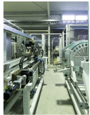
Die Anlagenaussicht, Trommelmagazin, Schwenkachse und Schneidkopf
