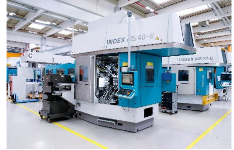
Index'e ait MS40C-8; büyük ve küçük üretim kapasiteleri için CNC çoklu kafa olarak tasarlandı..
