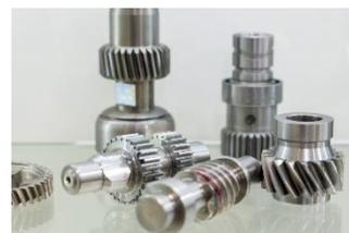
*I componenti per l'industria automotive sono prodotti tipicamente realizzati con un tornio multimandrino a CNC.*
