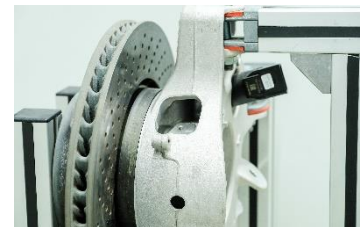
IMS Gear testet in Bremsenprüfständen das Langzeitverhalten von Parkbremsen. Dafür müssen die Antriebe exzellente Regelungseigenschaften mit sich bringen
