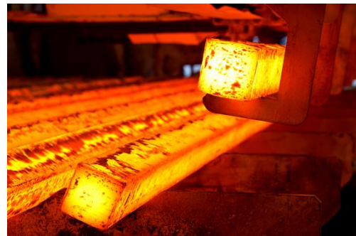
Kesilmiş olan metal çubuk sürekli döküm tesisini terkettikten sonra soğutma yatağına
