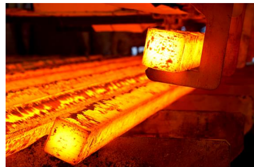
Billette tagliate sul letto di raffreddamento dopo essere uscite dall'impianto di colata
