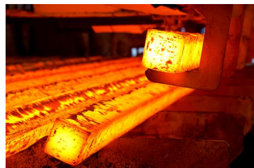
Geschnittene Knüppel auf dem Kühlbett nach Verlassen der Stranggießanlage
