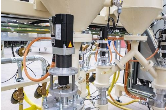
KOLLMORGEN'in AKM Servo motorları Tek kablo teknolojisiyle Roxor(ya da Shot peening) kumlama makinesinde (solda). Kumlama maddesi (kumlama tanecikleri) yüzey sıkıştırımda (sağda).
