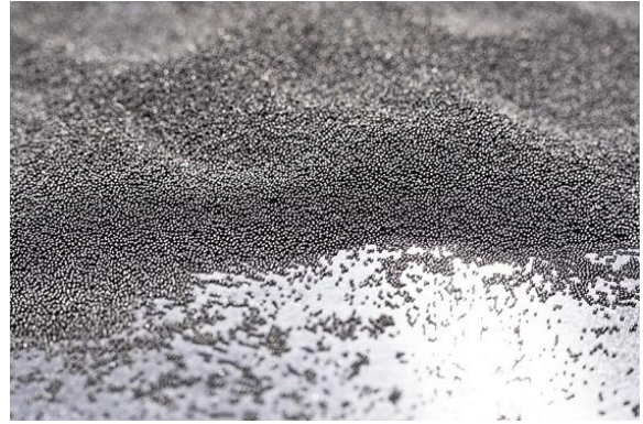
KOLLMORGEN'in AKM Servo motorları Tek kablo teknolojisiyle Roxor(ya da Shot peening) kumlama makinesinde (solda). Kumlama maddesi (kumlama tanecikleri) yüzey sıkıştırımda (sağda).
