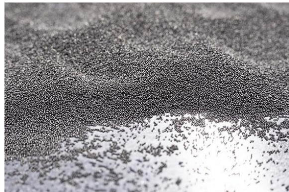
Servomotori AKM di KOLLMORGEN con sistema di collegamento a cavo singolo nell'impianto di pallinatura (o shot peening) Roxor (sinistra). Graniglia (pallini di acciaio) per la compressione in superficie (destra).
