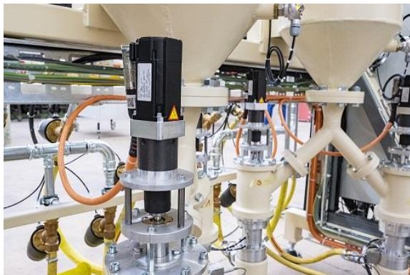
Servomotori AKM di KOLLMORGEN con sistema di collegamento a cavo singolo nell'impianto di pallinatura (o shot peening) Roxor (sinistra). Graniglia (pallini di acciaio) per la compressione in superficie (destra).
