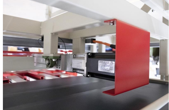
Solda KOLLMORGEN'in kompakt ve yüksek performanslı PCMM Kontrolörü ve AKD Servo güçlendiricisi. Sağ tarafta güçlü ivmelenmesiyle AKM Servo motor.
