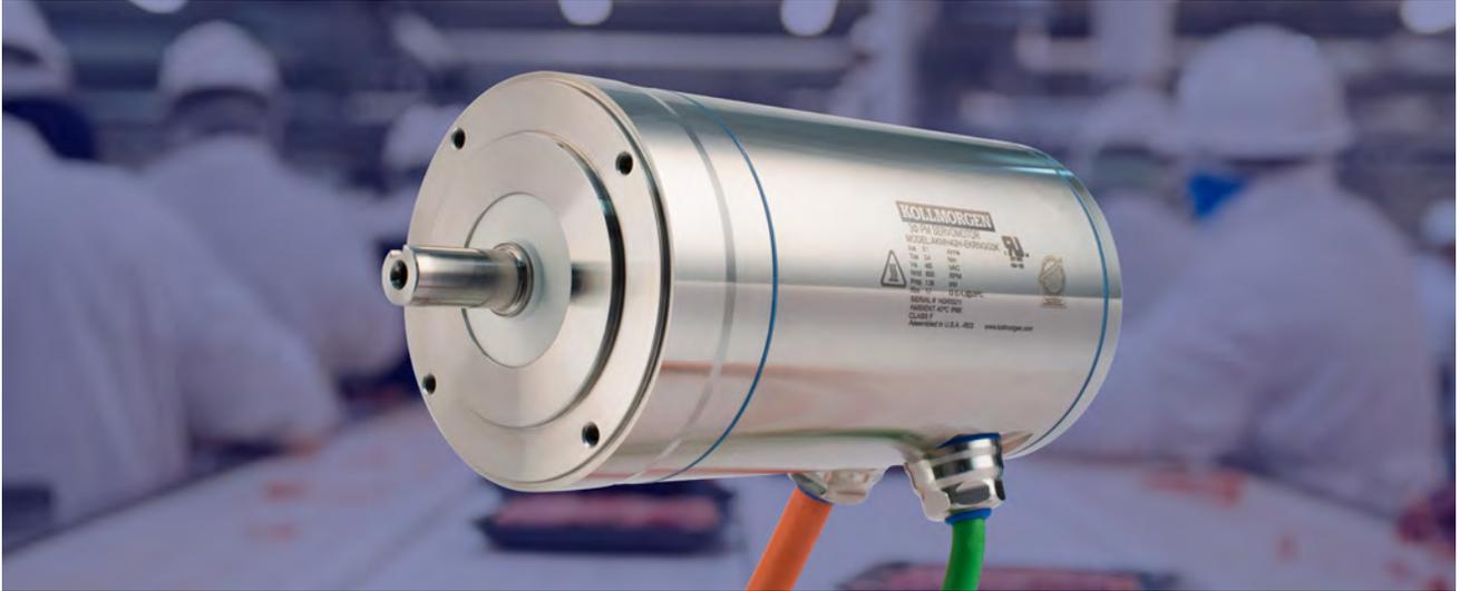
« L'extérieur du servomoteur AKMH est entièrement fait d'acier inoxydable 316. De plus, il est entièrement poli et présente une rugosité de surface inférieure à 0,8 µm. Tous les joints (incluant les joints toriques) répondent également aux exigences les plus strictes en matière d'hygiène. Même la plaque signalétique du moteur est estampée au laser sur le boîtier. Les moteurs en acier inoxydable de Kollmorgen sont un must dans le domaine de la production d'emballages alimentaires. »
