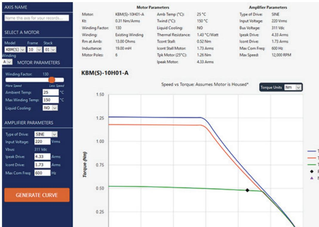
*Der Leistungskurvengenerator von Kollmorgen unterstützt Konstrukteure dabei, ein Gesamtsystem zu optimieren.*
