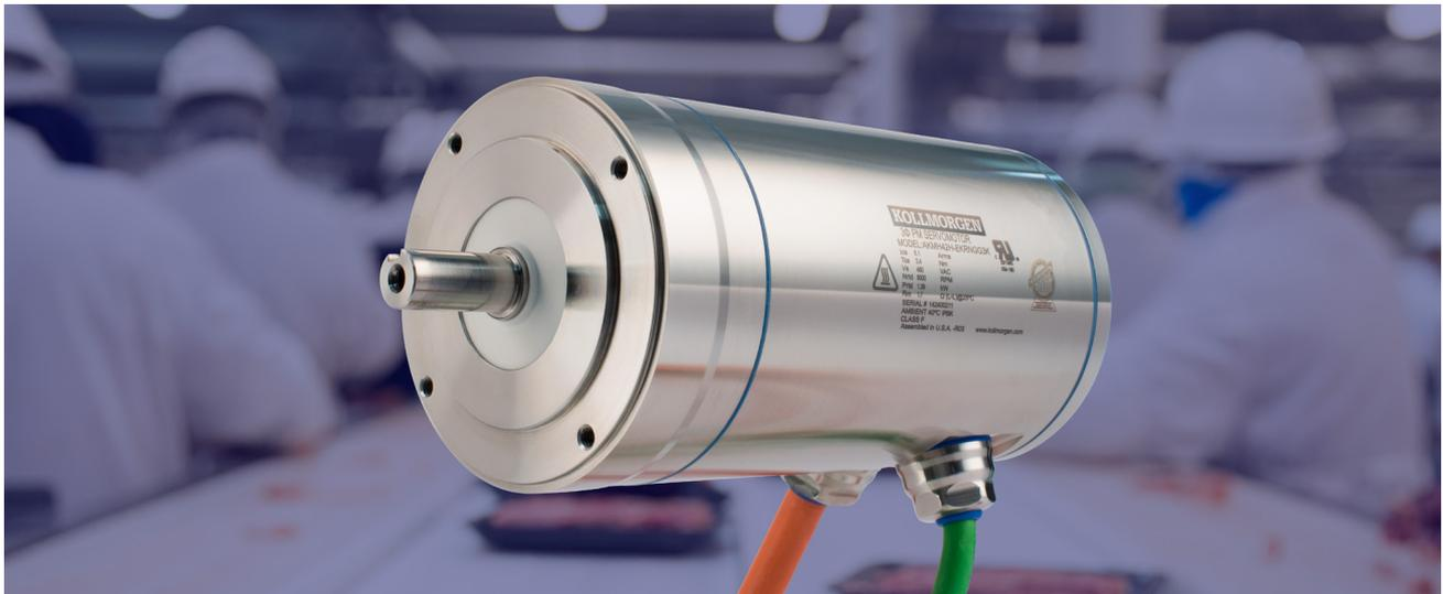
„Das Äußere des AKMH ist vollständig aus Edelstahl 316 gefertigt. Außerdem ist es vollständig poliert und hat eine Oberflächenrauheit von unter 0,8 µm. Alle Dichtungen und O-Ringe erfüllen außerdem die strengsten hygienischen Anforderungen. Sogar das Motortypenschild ist auf dem Gehäuse lasergraviert. Die Edelstahlmotoren von Kollmorgen sind das Nonplusultra für die Lebensmittelverpackungsproduktion.“
