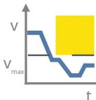
Achtet darauf, dass der Antrieb eine festgelegte Höchstgeschwindigkeit nicht überschreitet. Wenn ein Fehler auftritt, wird SS1 ausgelöst.
