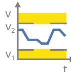
Monitora se o drive observa a faixa de velocidade definida. No caso de um erro, a SS1 é acionada.
