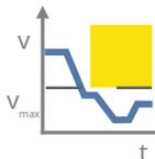
Monitora se o drive observa um limite de velocidade definido. No caso de um erro, a SS1 é acionada.
