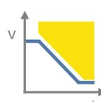
Uma frenagem controlada interrompe o movimento do drive, que permanece em repouso controlado. As funções de controle do drive são mantidas.
