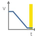
O drive para por meio de uma frenagem controlada. Então, a alimentação de energia para o motor é interrompida com segurança e o motor fica sem torque.
