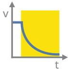
O STO interrompe com segurança o fornecimento de energia para o motor no servo drive. O motor fica sem torque.
