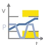
Monitora a posição absoluta do drive. Se o valor limite for atingido ou o torque do freio for muito baixo para manter o drive dentro do valor limite, a SS1 é acionada.
