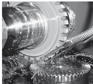
CNC-Bearbeitung eines PowerTRUE™ Zahnrades
